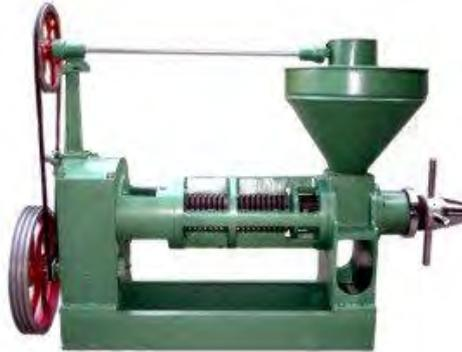
Figura 1: *Ejemplo de prensa expeller*
