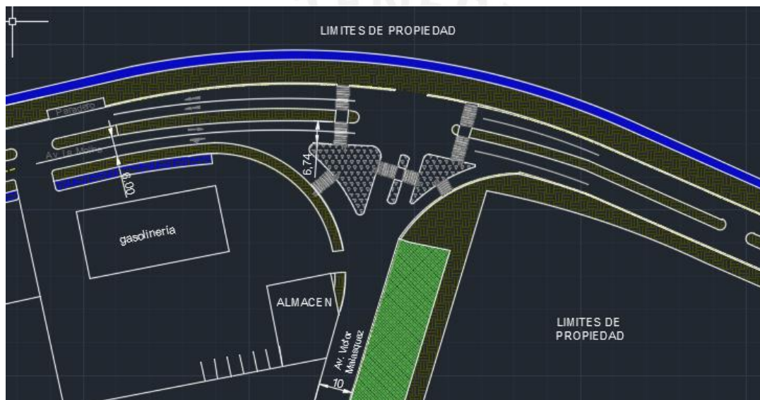
Figura 20 Representación en AutoCAD de la intersección
