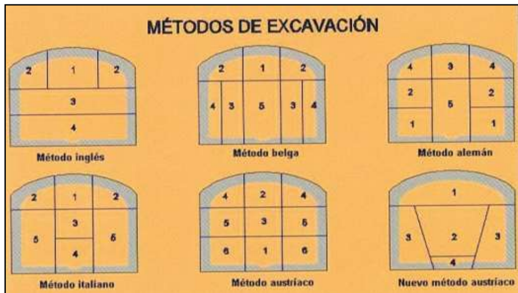
Figura 7: Secuencias de distintos métodos de excavación [8]
