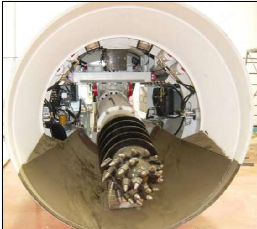
Figura 11: Escudo abierto con rozadora [12]
