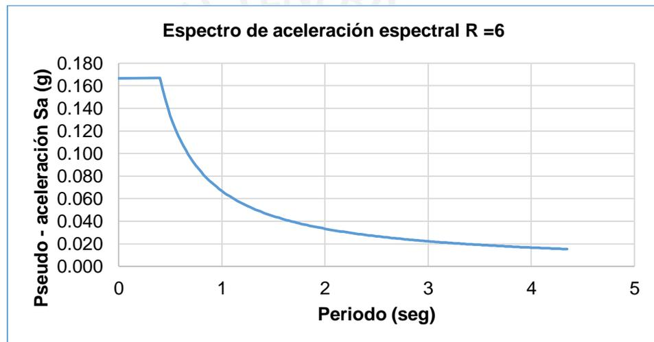
Figura 6. Espectro de aceleración espectral
