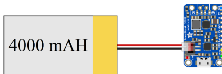
Figura 3.10: Diagrama de conexión Batería – Adafruit Power Booster 1000C
