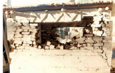
Figura 7.2 (a) Módulo de adobe reforzado y (b) después de ensayo sísmico (Ottazzi et al. 1989)
