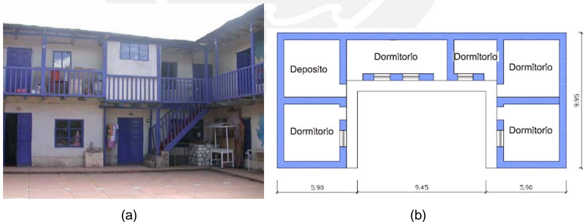
Figura 3.6 Vivienda con planta en forma de C: (a) Foto interior y (b) esquema en planta.
