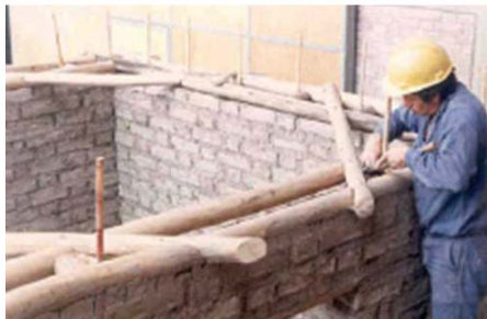
Figura 7.2 (a) Módulo de adobe reforzado y (b) después de ensayo sísmico (Ottazzi et al. 1989)
