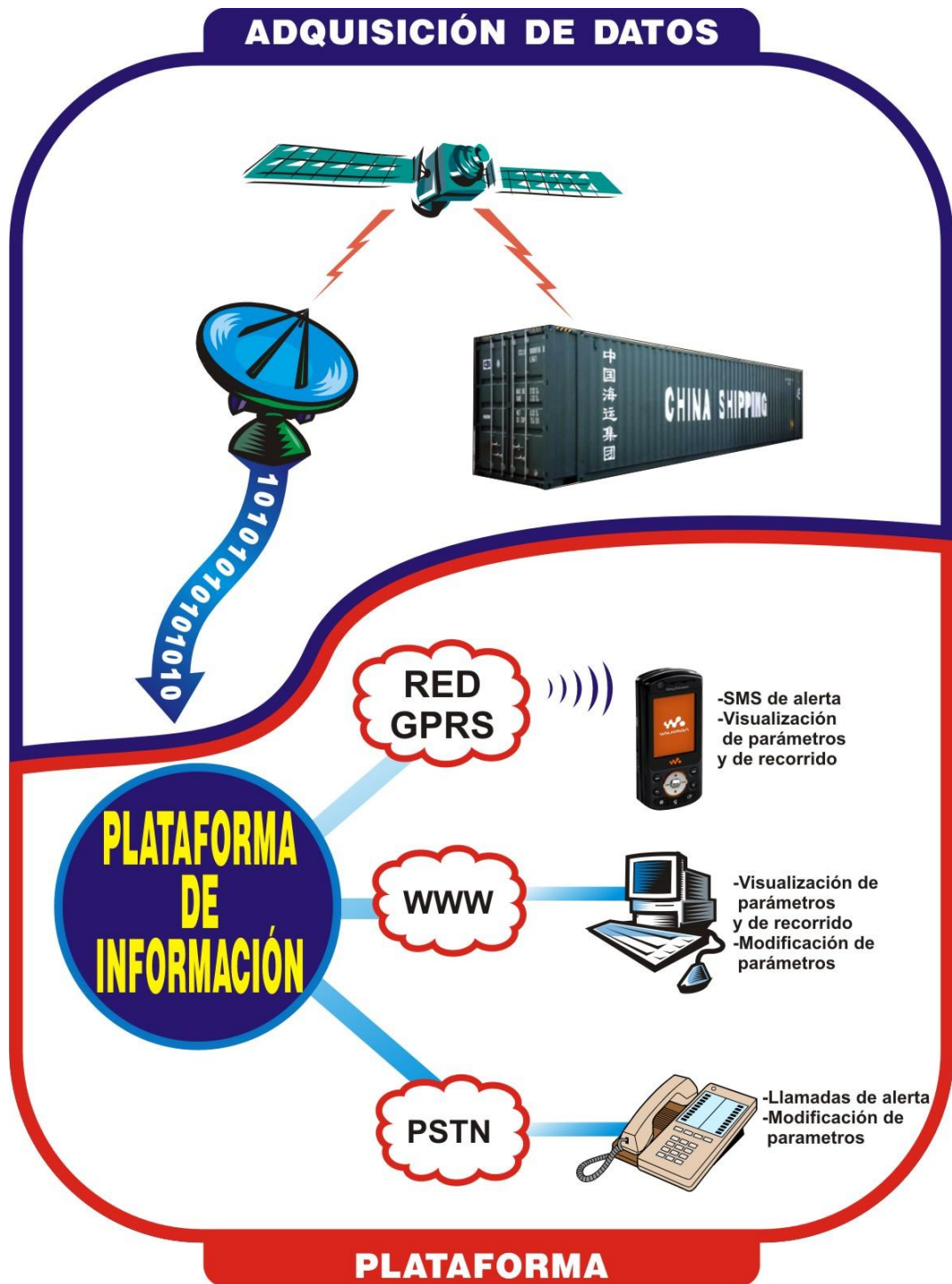
FIGURA 1-2: ESQUEMA DE LA SOLUCIÓN
