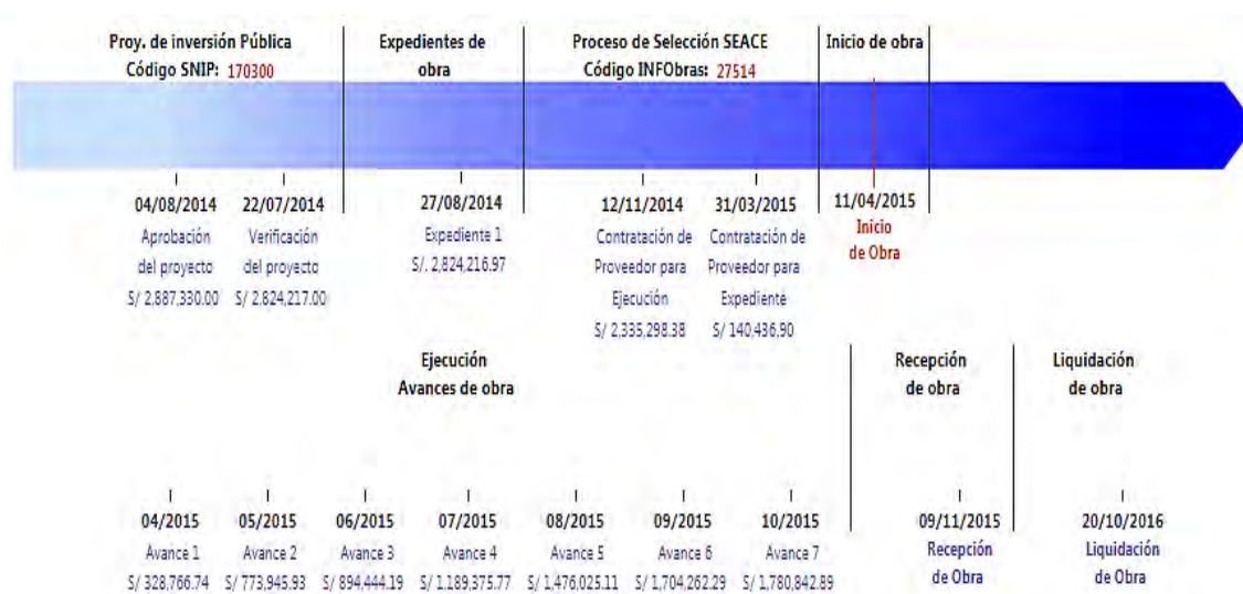
Figura 1.14. Cronograma desde aprobación del proyecto de la PTAR (04/08/2014) hasta la finalización de su ejecución (09/11/2015)
