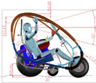
Mediciones y simulación ergonómica y biomecánicas de los discos de dirección de los miembros superiores del vehículo “PERUNATOR”
