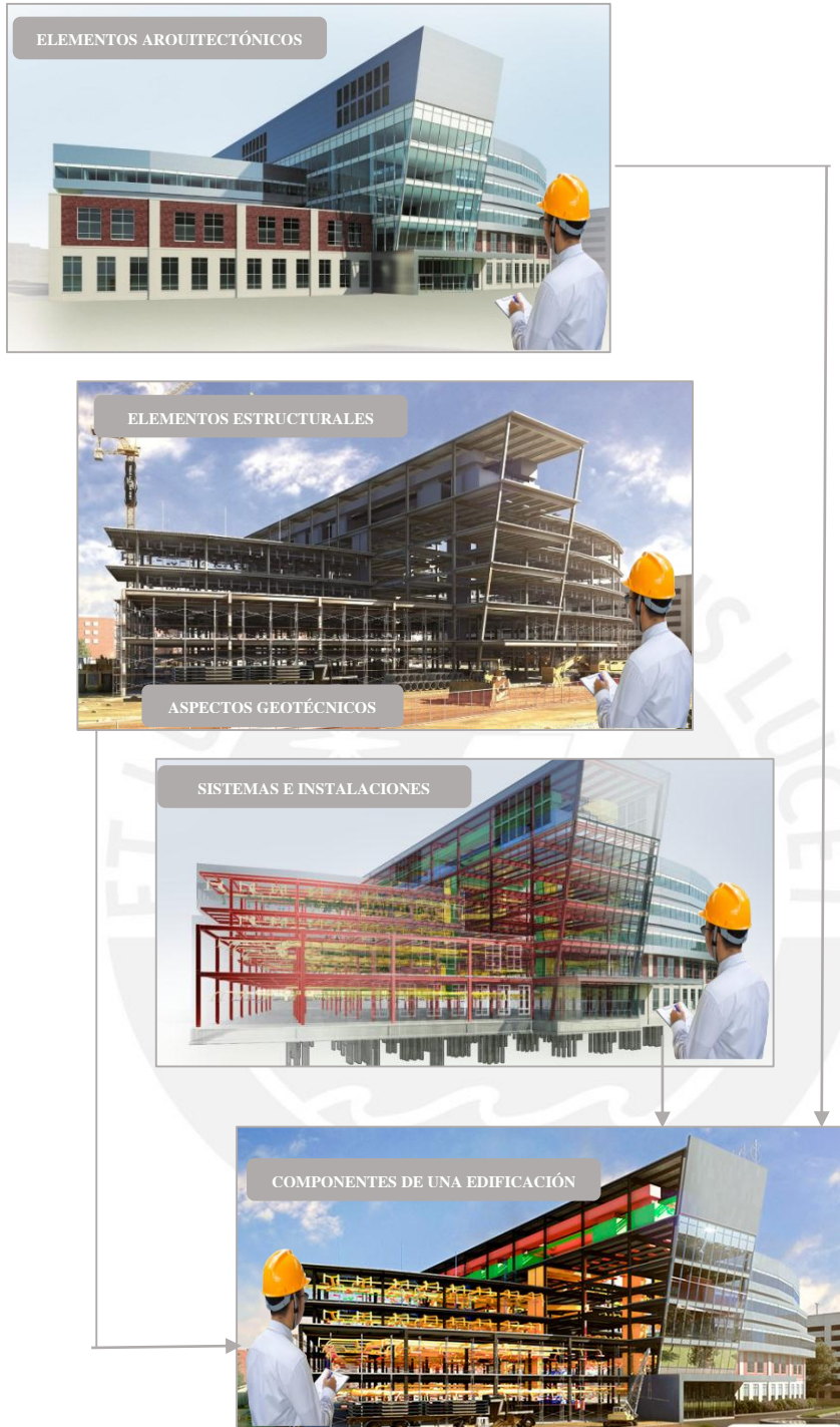
Figura 3.6 - Componentes de una edificación (Adaptado de: [7])
