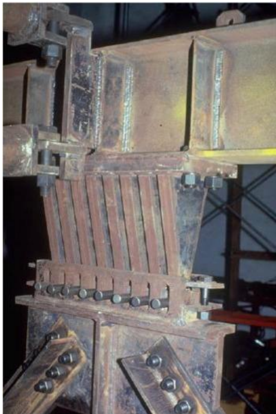
Figura 2.1 Dispositivo TADAS y conexiones [12]
