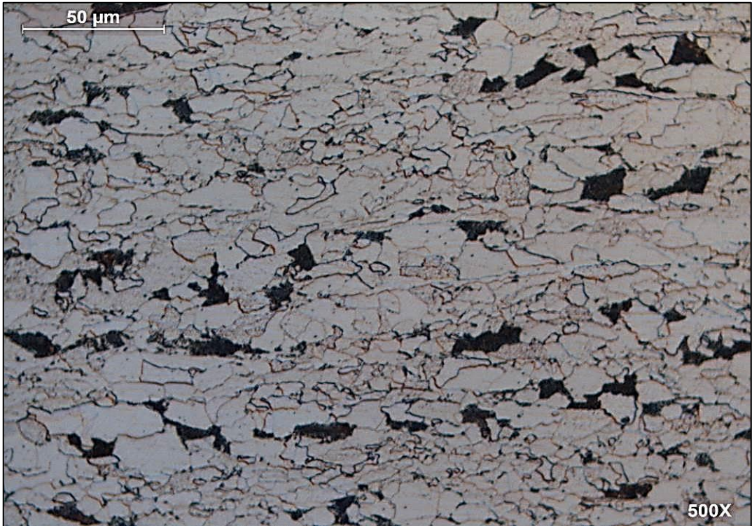
Figura 12. Tubería principal se observa una matriz de ferrita fina y presencia de perlita fina. Nital 2%. 500X.
