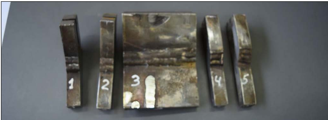
Figura 18. Probetas para el análisis macrográfico.
