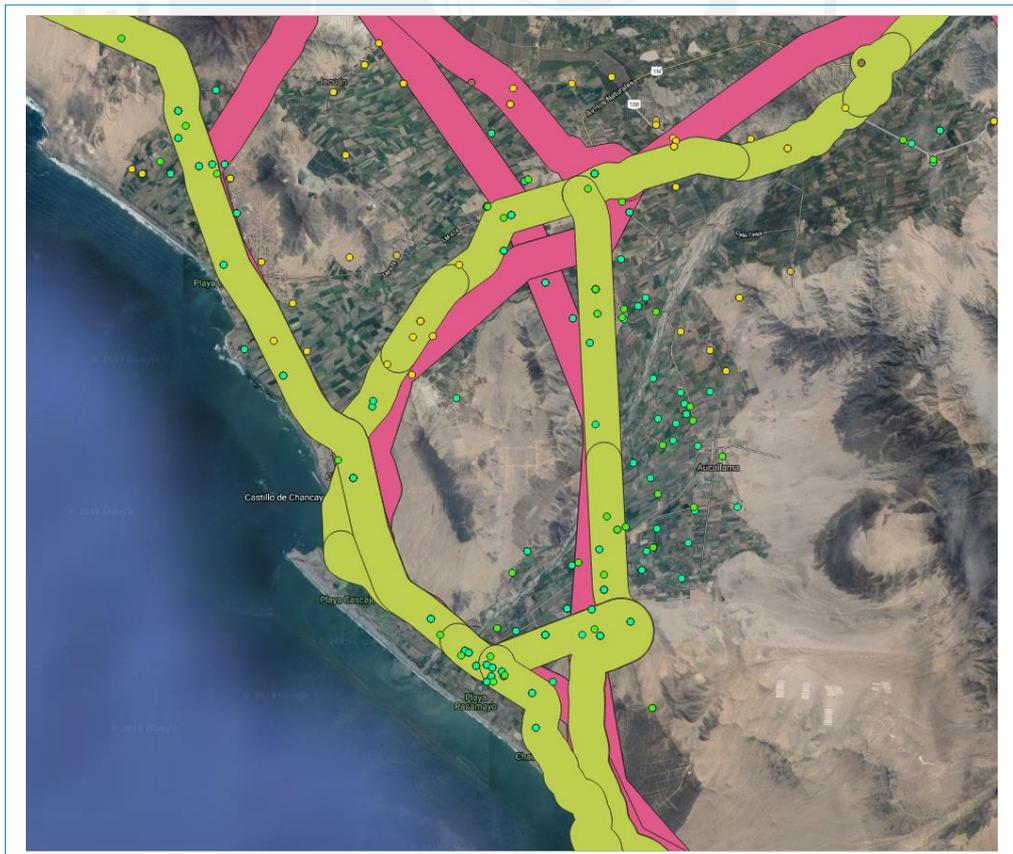
Figura 22: Buffer creado alrededor de líneas de transmisión y carreteras.
