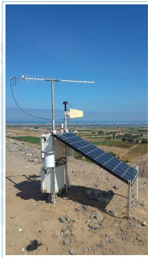
*Figura 7: Magnetómetro PM-05 instalado en Ite, Tacna*
