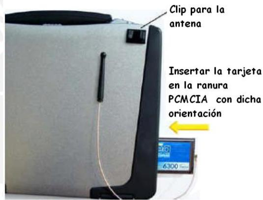
Figura 3.15 Colocación correcta de la tarjeta PCMCIA
