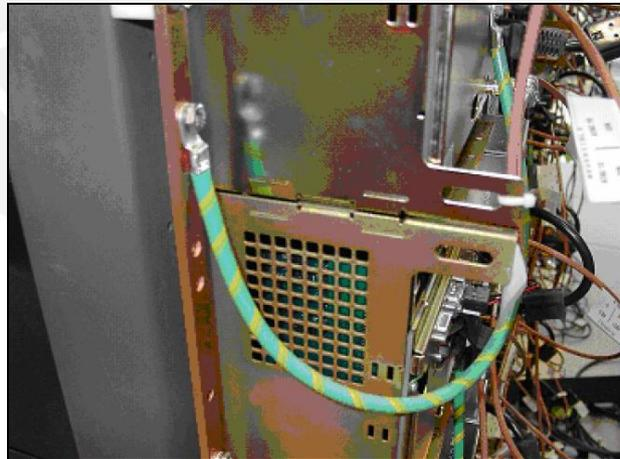
Figura 3.2 Rack montado para el equipamiento con conexión a tierra
