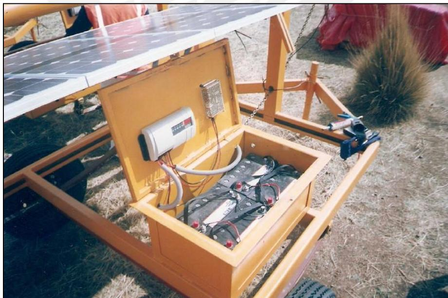
Figura 3.18 Equipamiento de con paneles solares y baterías instaladas
