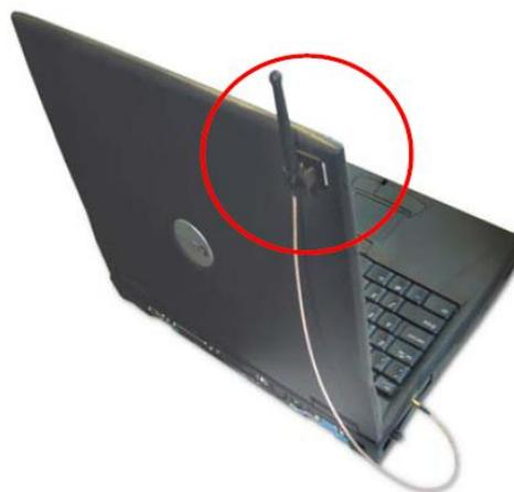
Figura 3.16 Orientación de la antena conectada a la tarjeta PCMCIA
