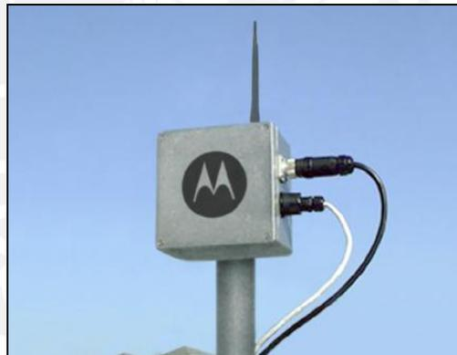
Figura 3.7 Dispositivo IAP instalado en un mástil fijo
