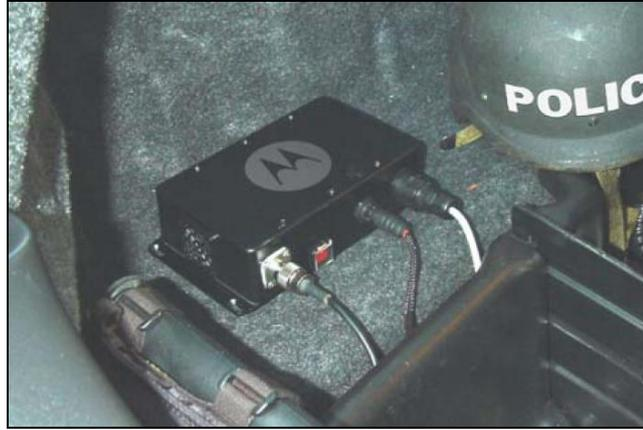
Figura 3.11 Ejemplo de montaje del VMM en los vehículos
