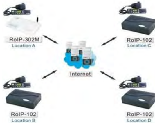
Figura 33: Diagrama Tipo de una Red con Terminales Remotos de DBL
