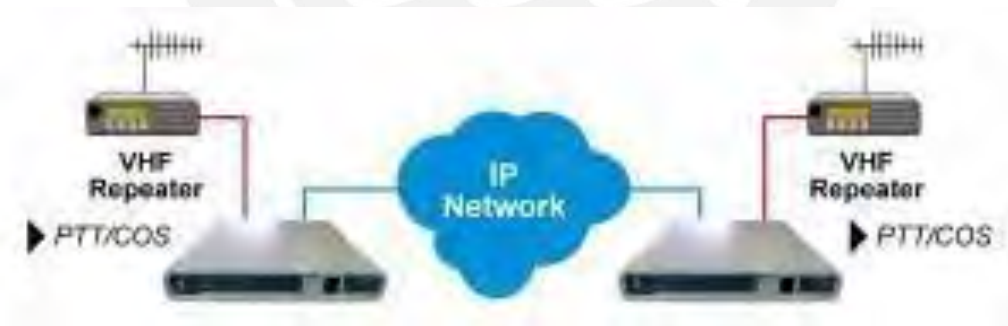
Figura 10: Diagrama Tipo de Conexión Back-to-Back de RoIP.
