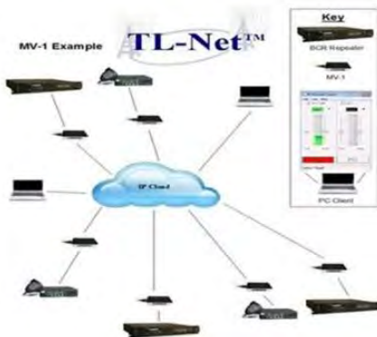
Figura 34: Diagrama Tipo de una Red con Terminales Remotos de BRIDCOM.
