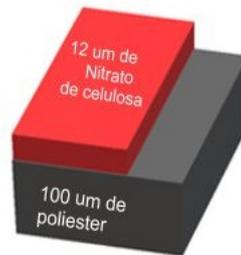
Figura 2.10: Detector LR-115 tipo 2
