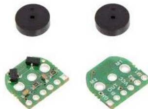
Figura 4.7: Encoders magnéticos de cuadratura. Fuente: Proveedor (Pololu.com)
