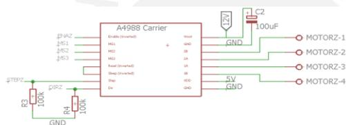
**Figura 5.11: Esquemático del excitador del motor de paso del eje Z**
