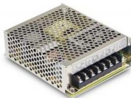
**Figura 4.20: Fuente conmutada del sistema.**
