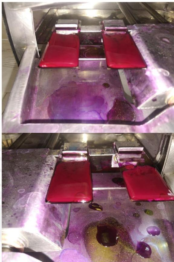
**Figura 6.11: Recubrimiento de fucsina de las muestras posterior al calentamiento.**
