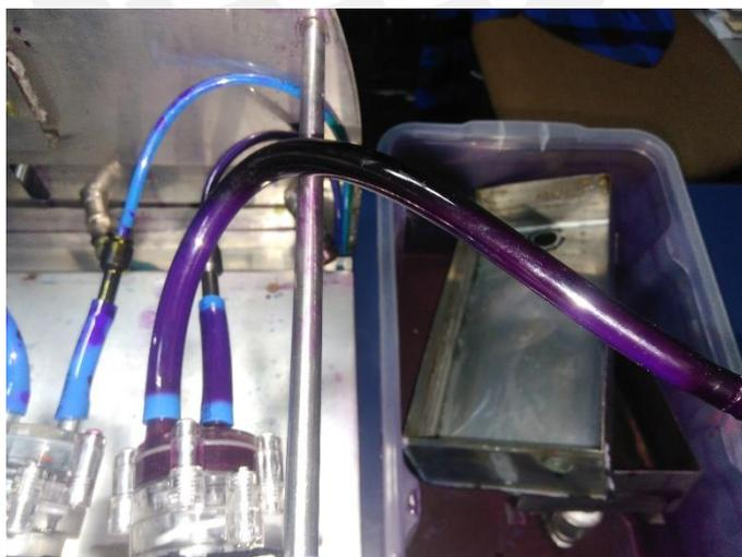
**Figura 6.2: Tubería de dispensado de fucsina**
