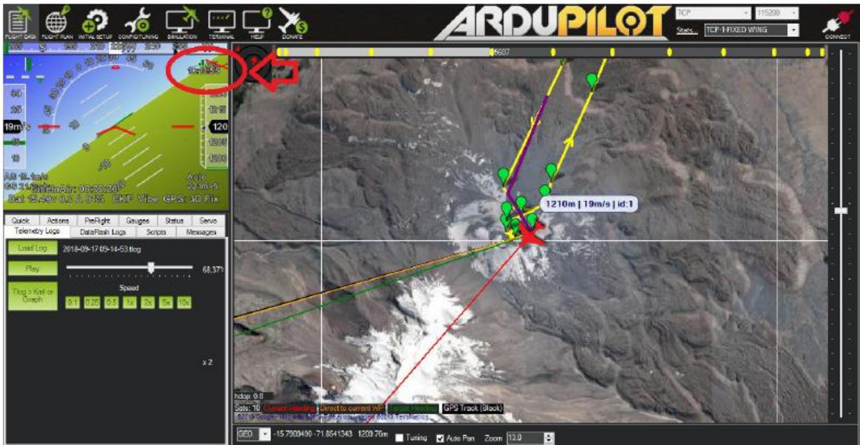
Figura 4.6 Punto de pérdida de conexión mostrado en el Mission Planner sin el sistema de comunicación desarrollado
