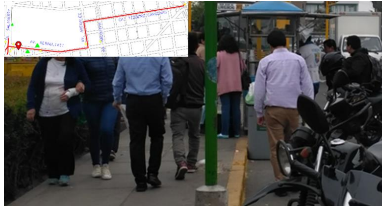
Figura 4.24 Veredas con ancho efectivo inadecuado. Fuente: propia
