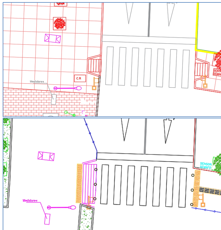
Figura 5.1 Rampa peatonal compatible con cruce peatonal en Av. Salaverry. Fuente: Propia
