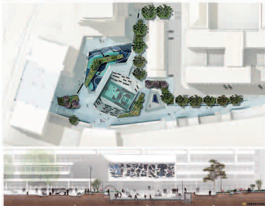
Sistema de plazas-depósito de aguas pluviales
