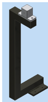
Figura 2-21: Soporte unión silla de ruedas - brazo robótico. Fuente propia.
