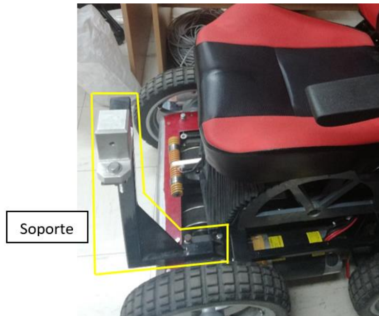
Figura 2-24: Ensamble silla – soporte. Fuente propia.
