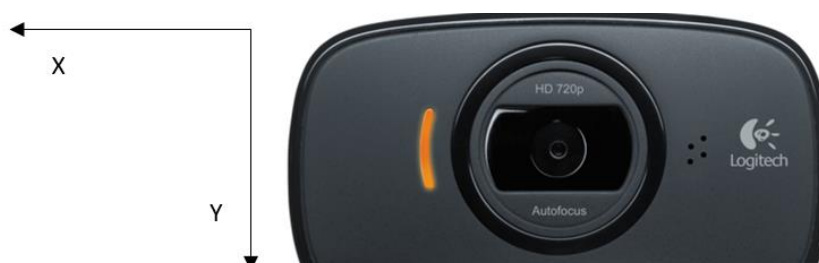
Figura 2-17: Coordenadas de la cámara derecha. [42]
