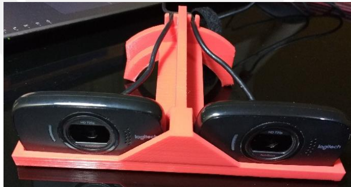
Figura 2-23: Soporte impreso en impresora 3D. Fuente propia.
