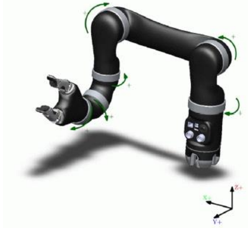
Figura 2-18: Coordenadas del brazo robótico. [33]
