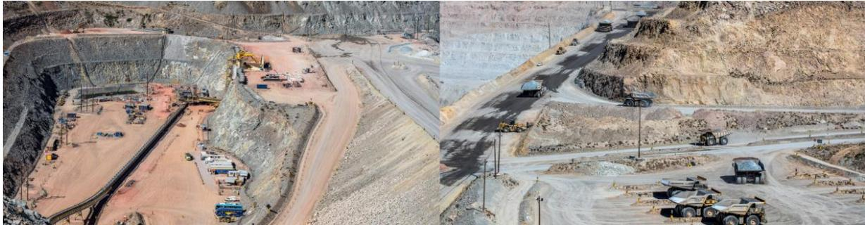
*Figura 11.* Acarreo con faja transportadora y camiones de gran capacidad en rampa
