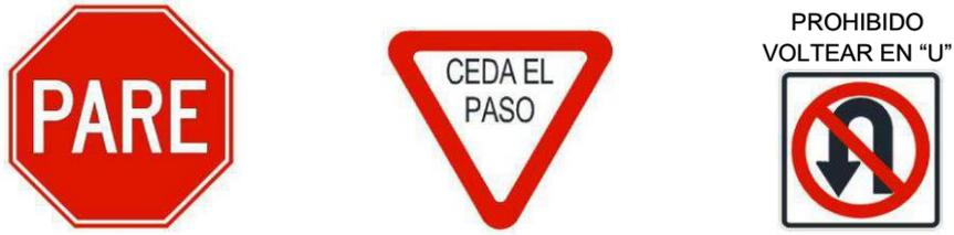
Figura 2.5. Señales verticales de reglamentación. Fuente: Manual MTC.
