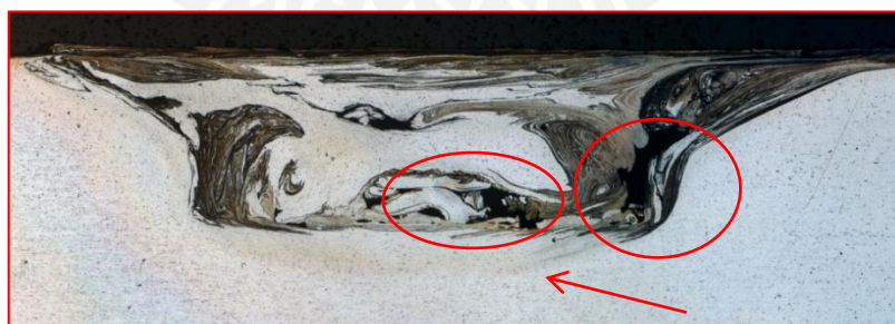
Figura 3.3 Probeta P1, los círculos muestran las cavidades tipo túnel. La flecha muestra el TMAZ.
