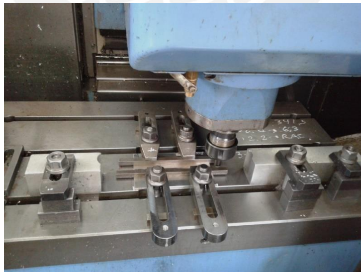
Figura 2.5 Muestra el inicio de fabricación de superficie compuesta de aluminio con nanotubos de carbono.
