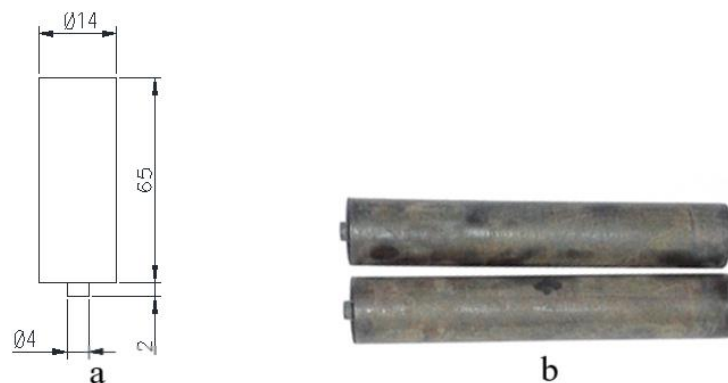
Figura 2.3 Se muestra el plano con las dimensiones de la herramienta(a); herramienta mecanizada con tratamiento térmico (b).
