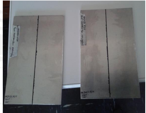
Figura 2.2 Probetas con nanotubos aglomerados en la ranura.
