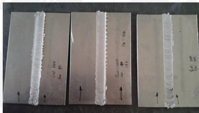
Figura 3.1 Apariencia superficial de la producción de superficie compuesta por FSP.
