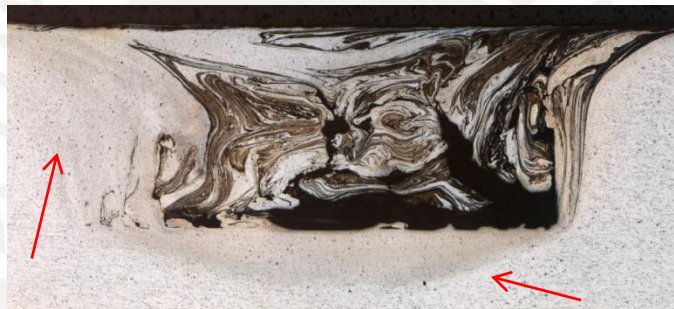
Figura 3.4 Probeta P2, En la imagen se aprecia la mayor extensión de la cavidades túnel. Las flechas muestran la zona termomecánicamente afectada.
