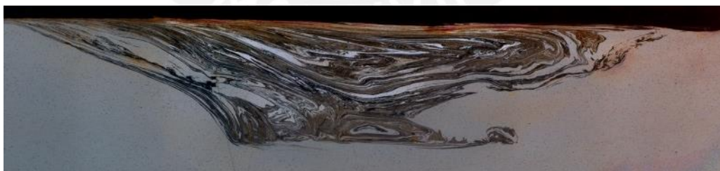
Figura 3.10 Probeta P5, se observa la mejor y mayor distribución de los nanotubos de todas las probetas evaluadas. Con un valor pitch de 0.2. Imagen a 50X.
