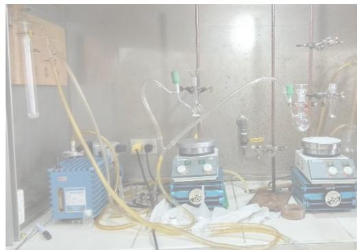
**Figura 59.** Sistema de polimerización bajo atmósfera inerte de nitrógeno.
