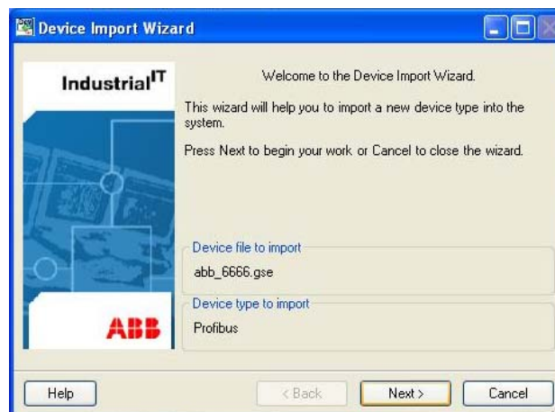
Figura 4.16: Paso 1, integración Profibus
