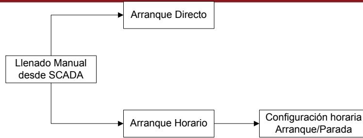
Figura 3.9: Tipos de Arranque Manual desde Scada
