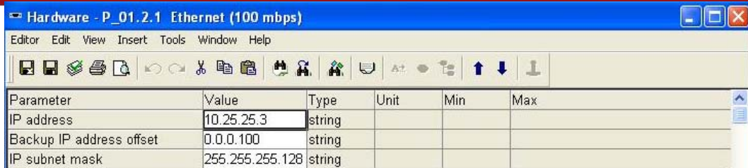
Figura 4.28: Configuración puerto de enlace de la interface Modbus TCP/IP CI867
