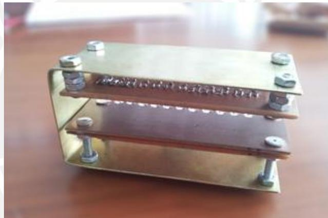
Figura 3.25: Arreglo fotoemisor-fotorreceptor, vista frontal
