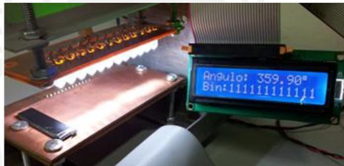
Figura 4.9: Prueba con el 12avo fototransistor cubierto
