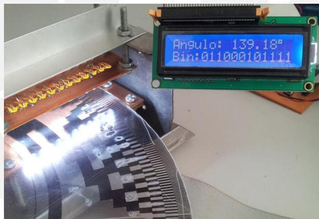
Figura 4.11: Primera prueba con el disco codificado
