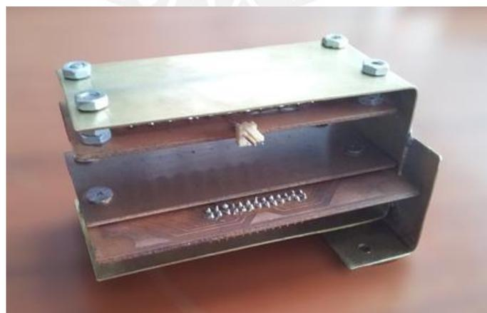
Figura 3.26: Arreglo fotoemisor-fotorreceptor, vista posterior
