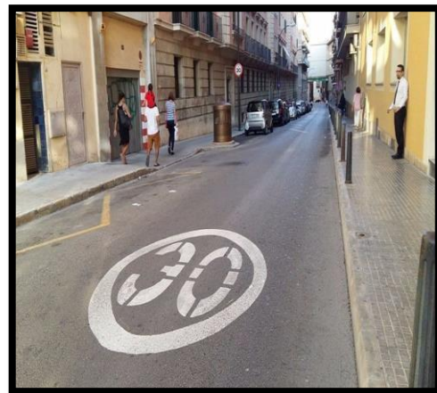
Figura 12: Señal horizontal de 30km/h
