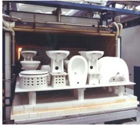
Figura 2 Vagoneta de carga para los hornos túnel. Fuente: (SACMI, 2005)
