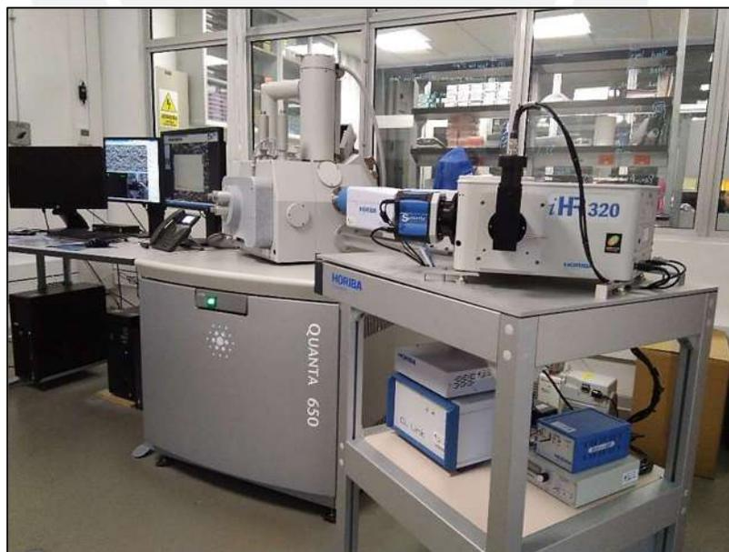
Figura 2.16: Microscopio electrónico de barrido (SEM)
