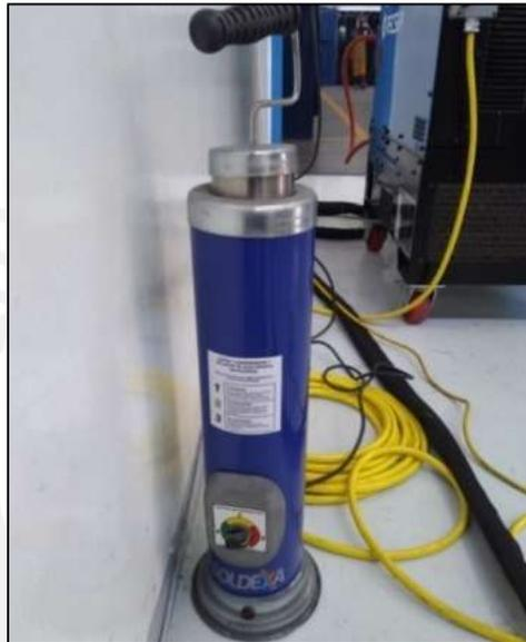
Figura 2.4. Horno portátil conservador y secador de electrodos revestidos
