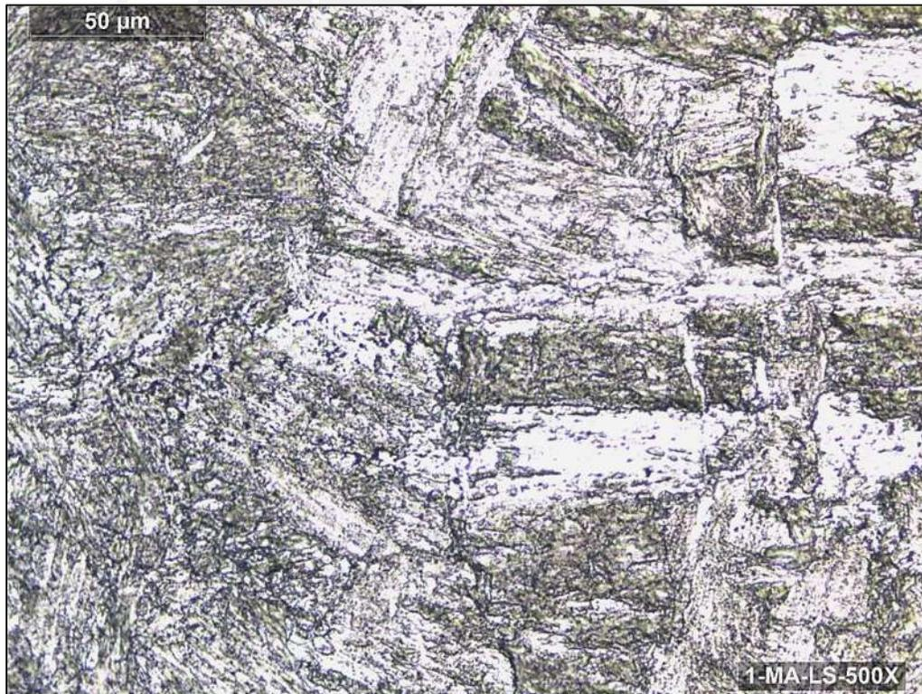
Figura 3.5. Microestructura de la junta J1 a 500X en la línea superior del metal de aporte (MA)
