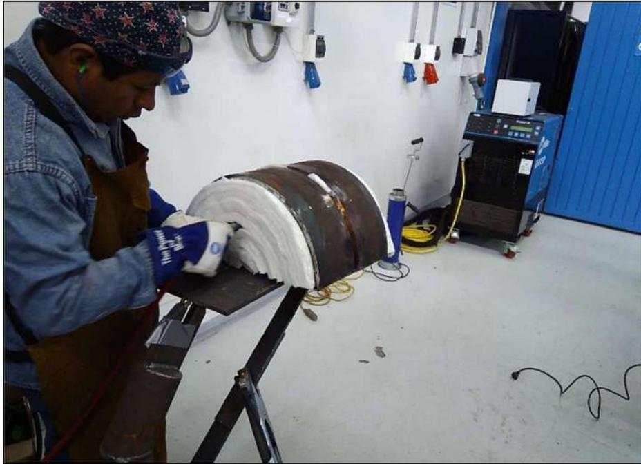
Figura 2.8. Introducción de la manguera del gas de respaldo dentro de la fibra cerámica
