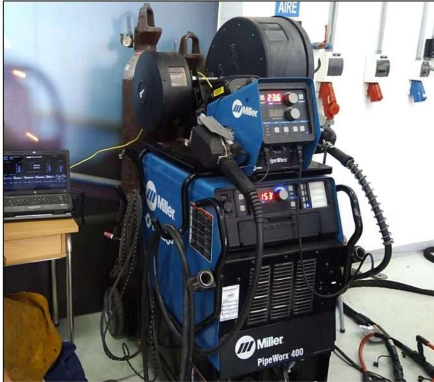
Figura 2.1. Equipo de soldadura PipeWorx 400 con registrador de datos conectado a la laptop
