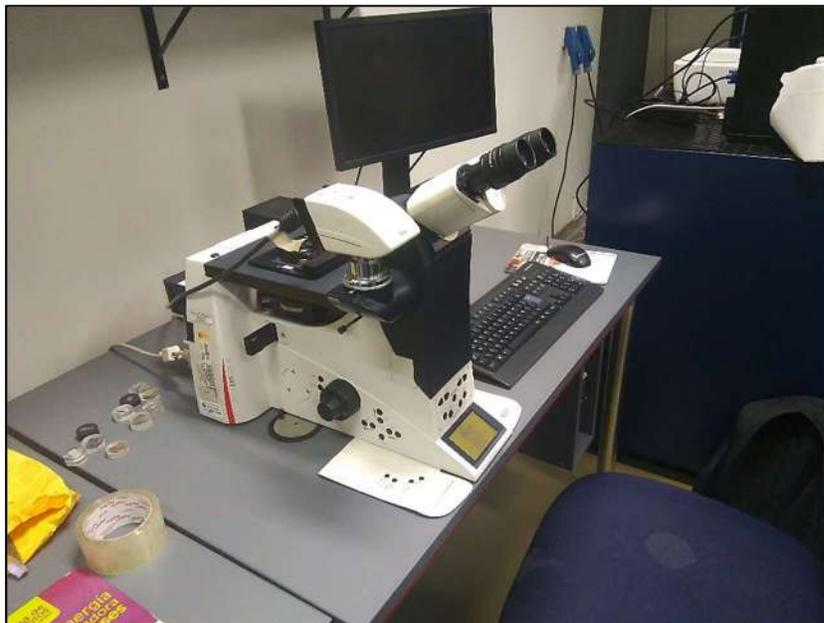
Figura 2.15: Microscopio óptico de luz reflejada para análisis metalográfico
