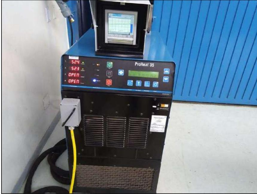
Figura 2.2. Equipo de calentamiento por inducción: con su registrador de datos, usando dos termocuplas de control
