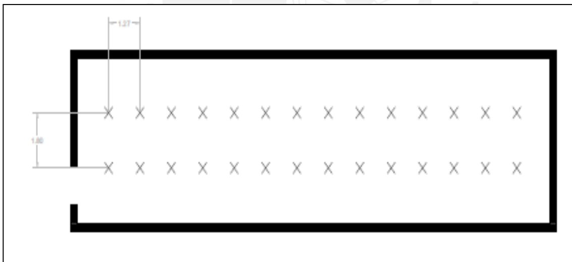
Figura 3.10 Distribución LEDs almacén segundo piso
