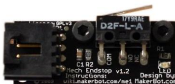
Figura 3.1.8-1. Sensor de fin de carrera ( Limit switch )
