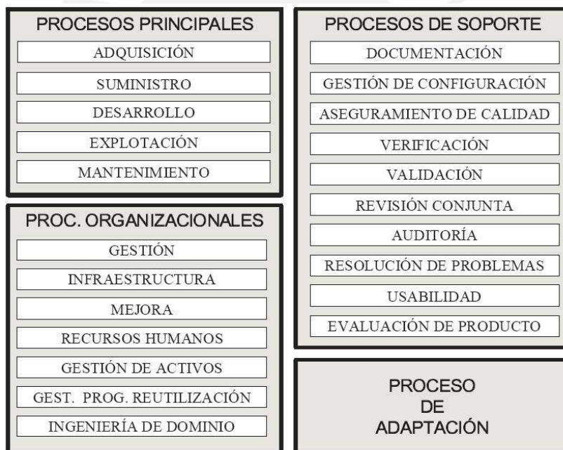
Figura 1.1 Estructura de la Norma ISO/IEC 12207:2004 [RUI2008]
