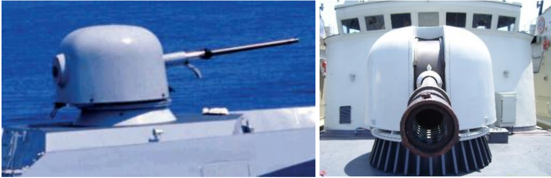
Figura N°5: Vistas del Cañón Oto Melara 76/62 mm (Imágenes fuente Marina de Guerra del Perú)
