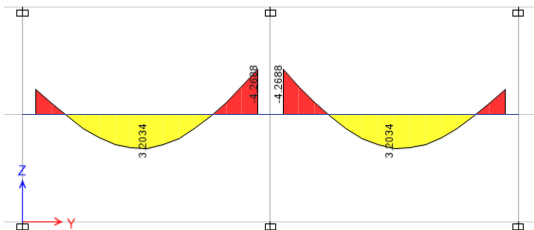
Figura 20. Diagrama de momento flector por carga viva para viga V02 (tn). Fuente: Datos obtenidos de modelo de viga en ETABS.
