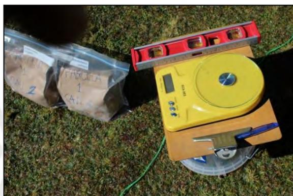
Imagen N° 2. Muestras de suelo pesadas y almacenada para derivarse al laboratorio
