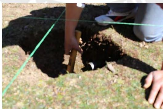
Imagen N° 6. Cilindro introduciéndose en una de las caras laterales de la calicata
