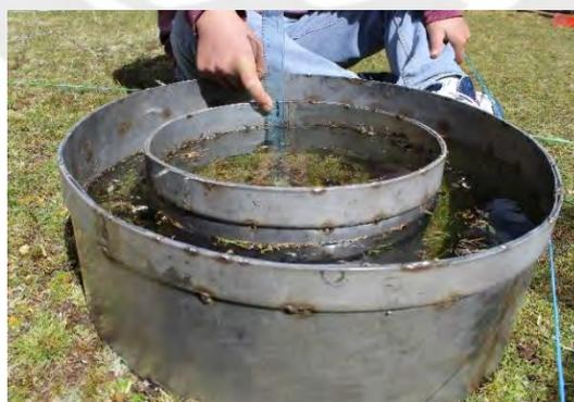
Imagen N° 4. Ensayo de infiltración en curso
