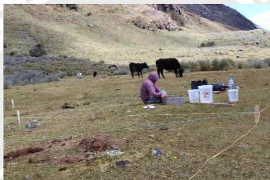
Imagen N° 3. Proceso de Instalación de los anillos en las subparcelas
