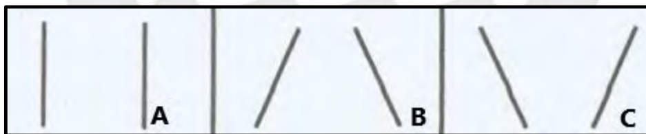
Figura 3.27. Forma de los golletes. A = recto. B = cónico. C = cónico invertido (modificado de Muro 2009: 129, figura 93).
