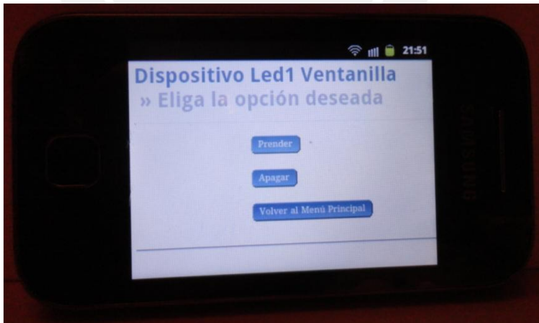
Figura 7.4 Usuario Wally eligió el dispositivo Led 1 Abancay, la imagen muestra las opciones que tiene este dispositivo (Prender, Apagar, y volver al Menú Principal)
