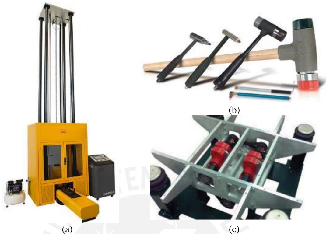
Figura 2.2: Ejemplos de mecanismos de excitación forzada: (a) sistema de caída de peso (www.ecer.com), (b) martillos de impacto (www.pcb.com) y (c) vibrador de masa excéntrica (www.vstcorp.com, Maria Masciotta, 2015)
