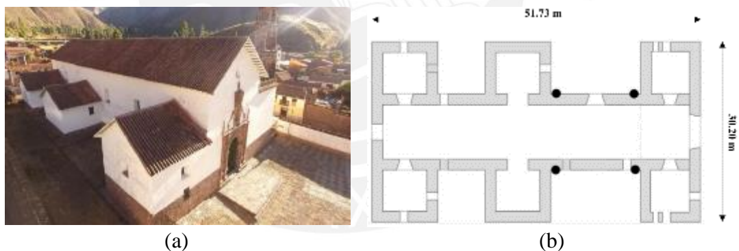
Figura 5.13: Iglesia de San Juan Bautista de Huaro: (a) vista general de la iglesia y (b) esquema en planta con la ubicación de los acelerómetros para el sistema de monitoreo dinámico a largo plazo (Zonno, Aguilar, Castañ, et al., 2018).
