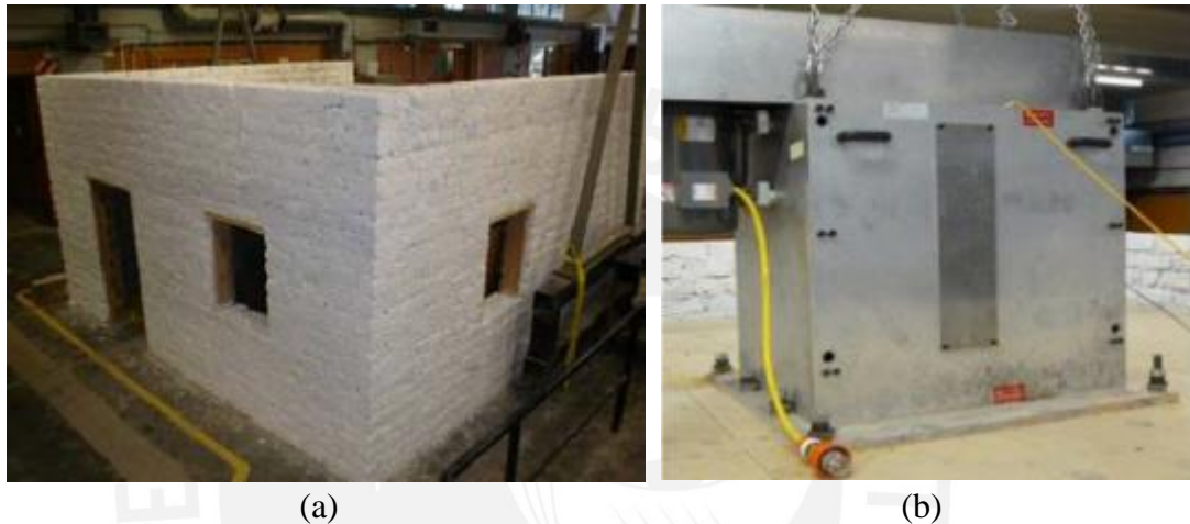
Figura 2.41: Identificación de daño en un módulo de vivienda de mampostería sin refuerzo: (a) estructura en el laboratorio y (b) vibrador de masa excéntrica para la aplicación de daño (Oyarzo-vera et al., 2014)
