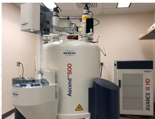
**Figura 5.9** Equipo de resonancia magnética nuclear (RMN).
