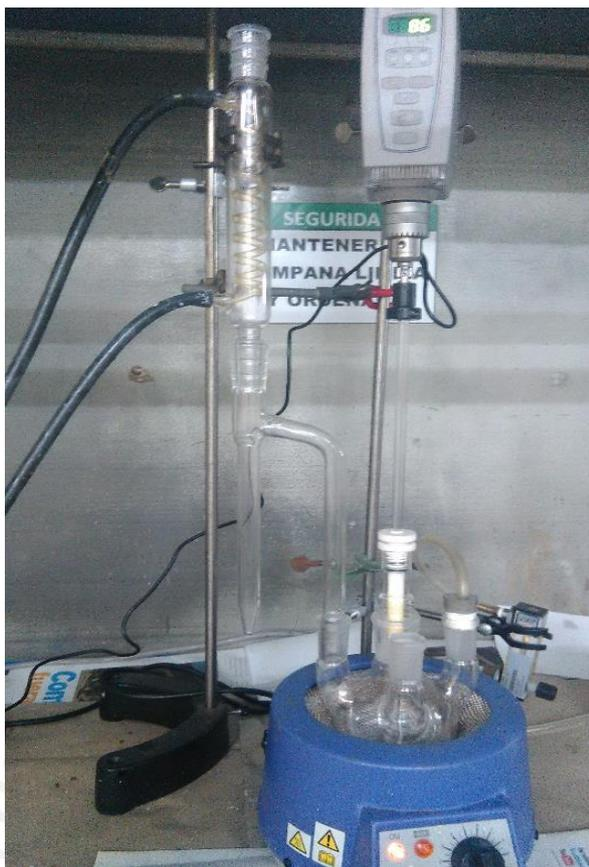
**Figura 5.1** Montaje del reactor de síntesis de las resinas alquídicas.
