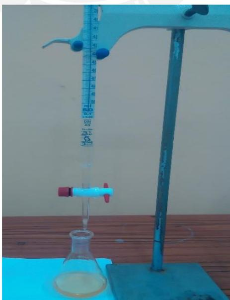
**Figura 5.4** Montaje realizado para la titulación de las muestras.
