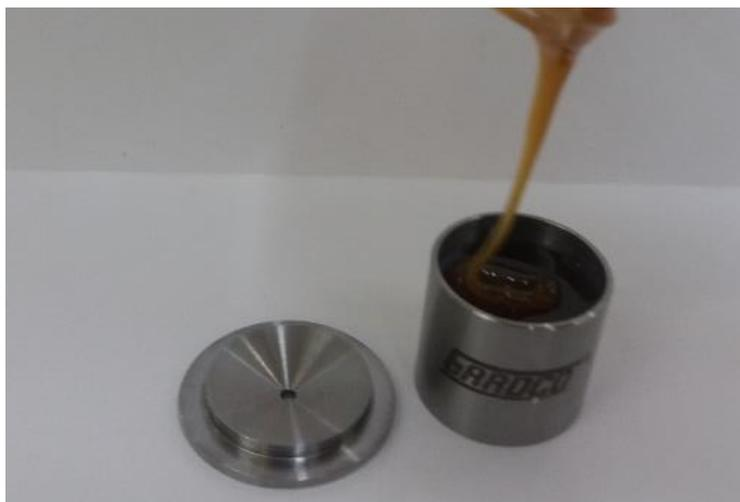
**Figura 5.6** Copa Gardner WG-SS-8,32 y llenado de resina para la medición de la densidad.
