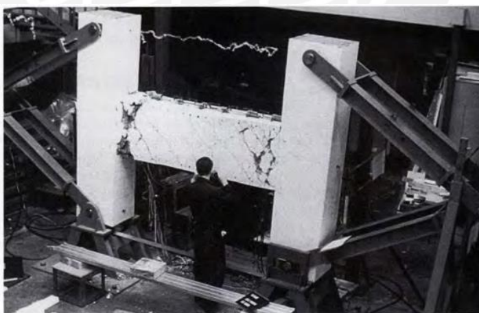
Figura 4.1: Ensayo de pórtico con conexión emulativa.
