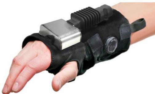
Figura 1.9: Órtesis de amortiguamiento *Steadiwear*<sup>12</sup>
