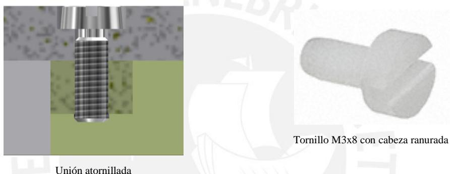
Figura 4.15: Ensamble por unión atornillada
