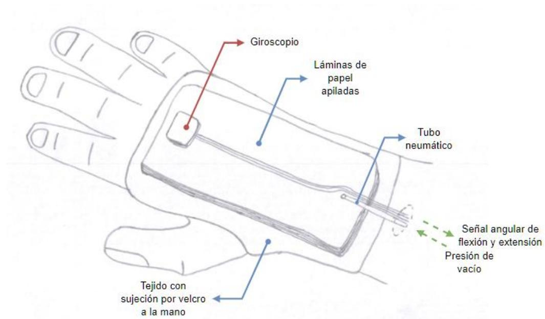
Figura A.5: Concepto de solución 3 – dispositivo amortiguador
