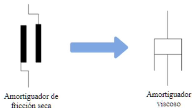
Figura 3.15: Equivalencia en amortiguador viscoso
