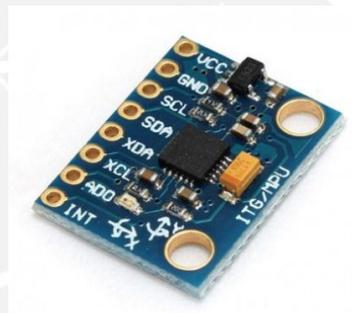
Figura 1.16: Sensor inercial MPU-6050<sup>14</sup>
