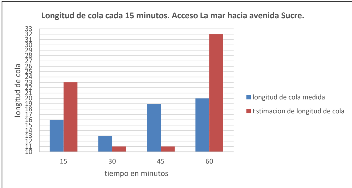
Figura 31. Comparación entre longitud de cola medida y calculada
