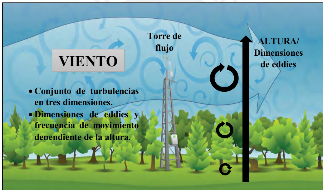
Figura 2.1. Representación del comportamiento de los flujos turbulentos y aire en un ecosistema. Modificado de: Eddy Covariance Method, LI-COR Biosciences. Burba, 2013.
