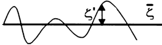
Figura 2.4. Representación gráfica de la descomposición de Reynolds. Fuente: Foken, 2008)
