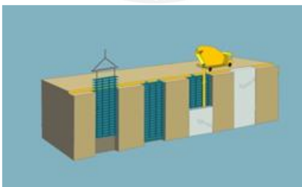
Fig. 27 - Instalación de armaduras de refuerzo y vaciado (Emblse contreras, 2011)
