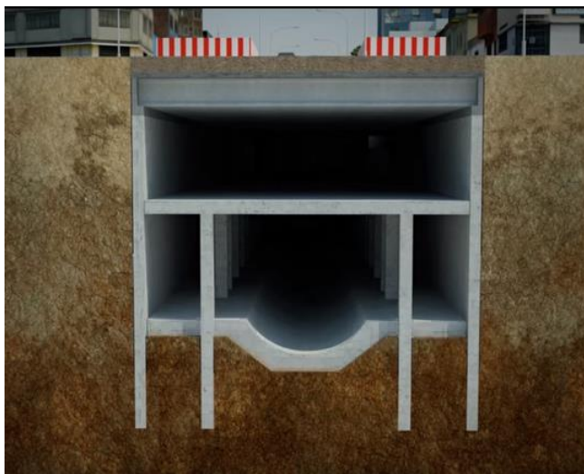
Fig. 31 - Plataforma inferior Cut and Cover (Proinversión 2012)
