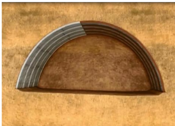
Fig. 14 - Segunda capa de hormigón proyectado (Azvi studios, 2010)
