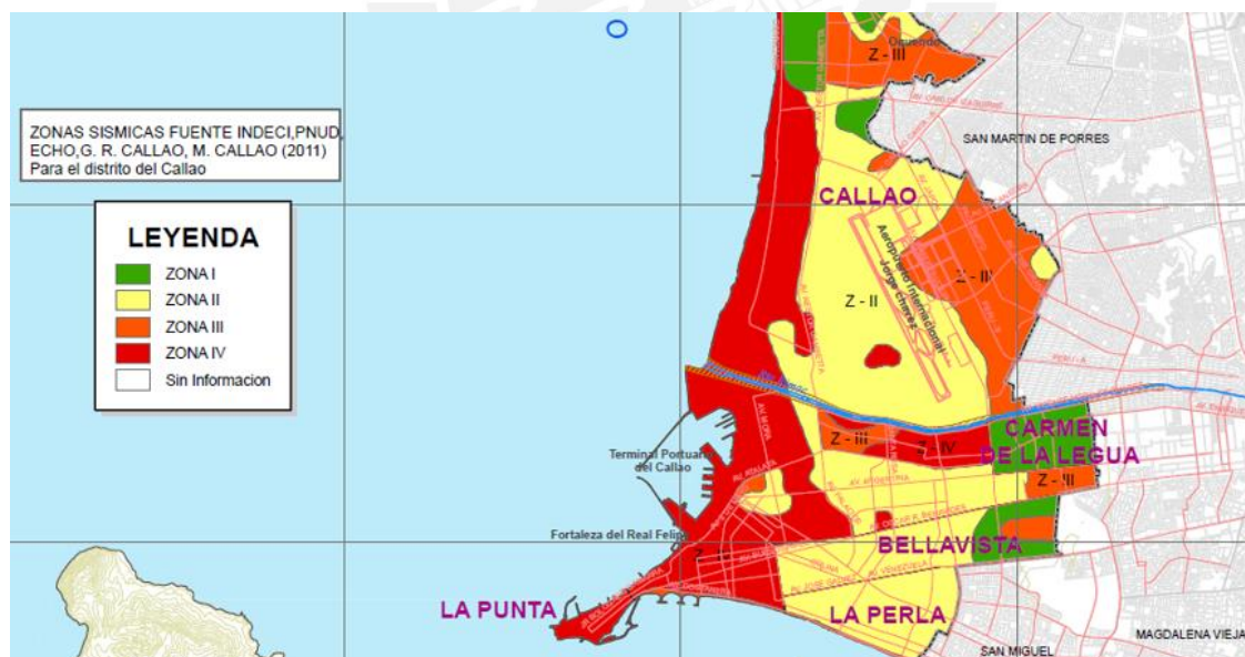
Fig. 40 - Mapa de sismicidad, oficina de acondicionamiento territorial Callao. (INDECI, CISMID, et al. 2011)
