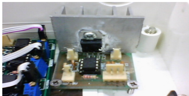
Figura 19: Circuito final de la fuente de alimentación.
