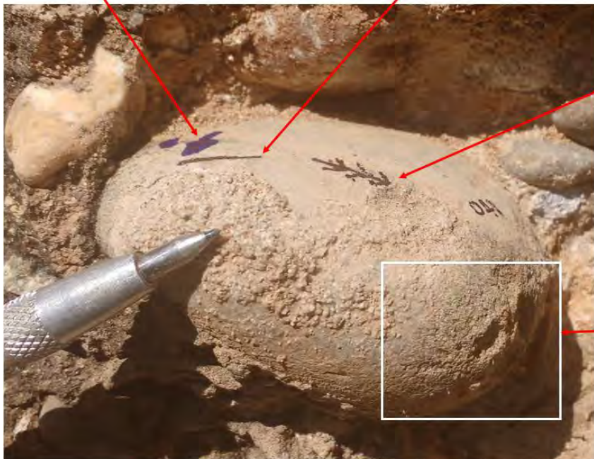
Figura 2-11 Anotaciones hechas en campo sobre la superficie de cada clasto en su posición in-situ antes de extraerlo. Nótese las marcas de disolución visibles en la superficie expuesta de esta grava
