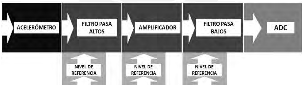
Figura 4.6: Diagrama de bloques de la 2 da propuesta de diseño de la unidad de adquisición de datos de aceleración. Fuente: Elaboración propia.
