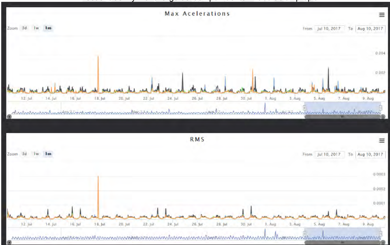
Figura 3.10: Gráfico de las aceleraciones máximas (g) y RMS (g) vs tiempo Huaru (fecha: hora) de la Iglesia San Juan Bautista de Huaru. Los picos máximos de aceleración se asocian a señales de excitación ambiental generadas por tráfico vehicular, tráfico peatonal, movimientos telúricos leves o la fuerza del viento. Fuente: Elaboración propia.
