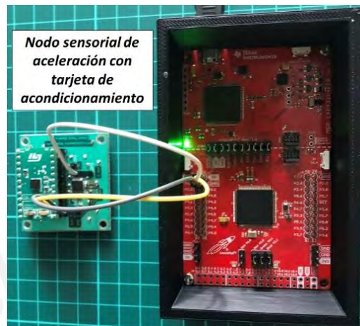
Figura 5.11: Tarjeta MSP-EXP432P401R conectada a la primera tarjeta de acondicionamiento de señales 0 diseñada. Adhesión con cera de abeja en la parte posterior.
