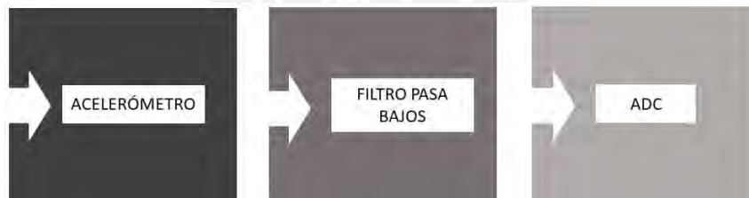
Figura 4.2: Diagrama de bloques de la 1 era propuesta de diseño de la unidad de adquisición de datos de aceleración. Fuente: Elaboración propia.
