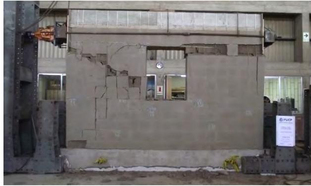
Figura 6.7: Muro a escala natural reforzado MUENCR al término del ensayo
