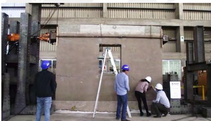
Figura 6.3: Marcación de grietas del muro MUENSR durante la fase 6
