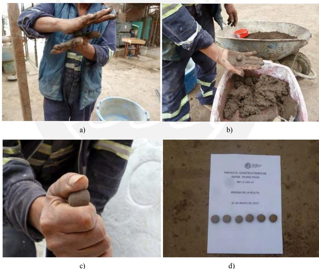
Figura 3.1. a) Amasado de tierra para formar bolita, b) Bolita elaborada, c) Prueba de la bolita y d) Bolitas al término del ensayo
