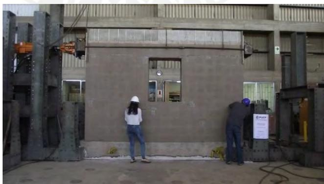
Figura 6.6: Marcación de grietas en el MUENCR durante la fase 6
