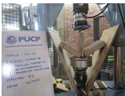
Figura 3.12. Ensayos de emparedados de adobe (E-2) a tracción indirecta
