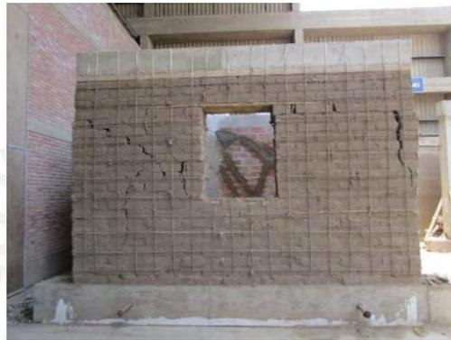
Figura 6.8: Muro MUENCR sin tarrajeo al término del ensayo
