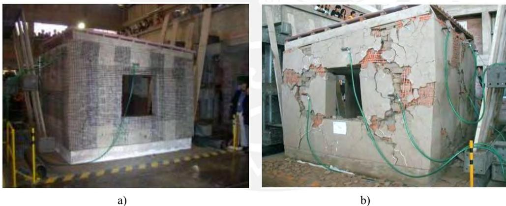
Figura 2.10. a) Módulo de adobe reforzado con 75% de geomalla después del ensayo, b) Módulo de adobe reforzado al 50% con malla plástica tras sufrir un sismo moderado  $D= 80$  mm (Blondet et al., 2011 y Blondet et al., 2006).
