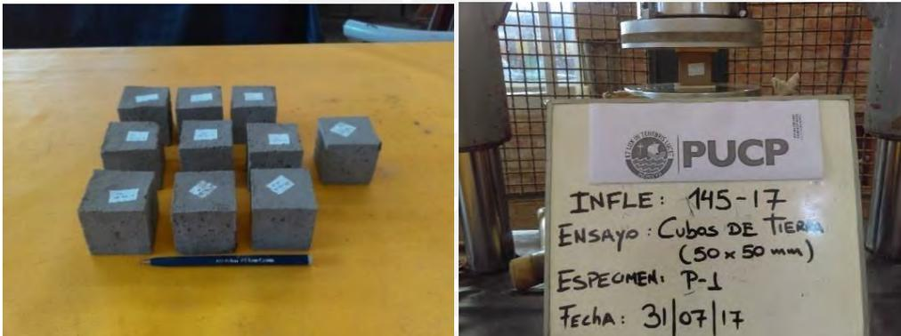
a) Cubos de mortero antes del ensayo
