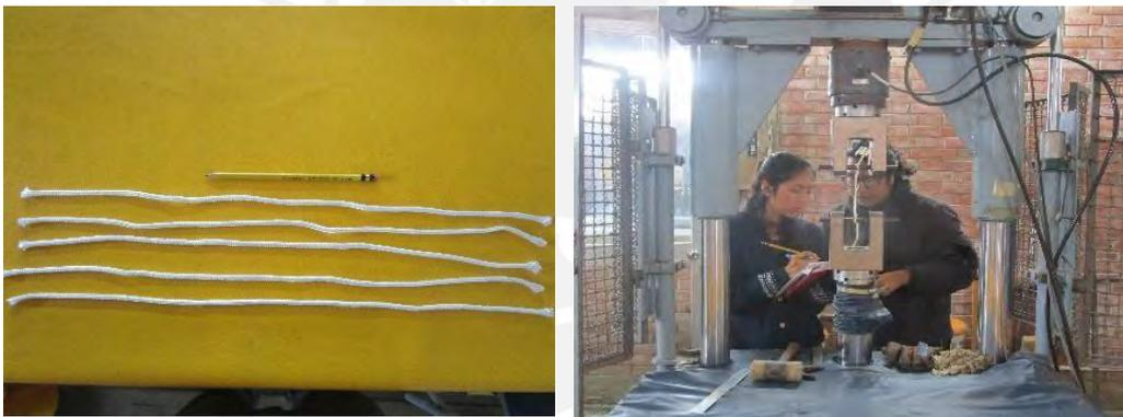
Figura 3.29. Preparación de probetas para el ensayo de tracción en drizas
