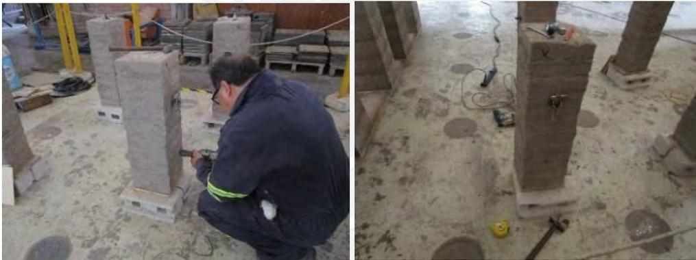
Figura 3.15. Instrumentación en pilas de adobe
