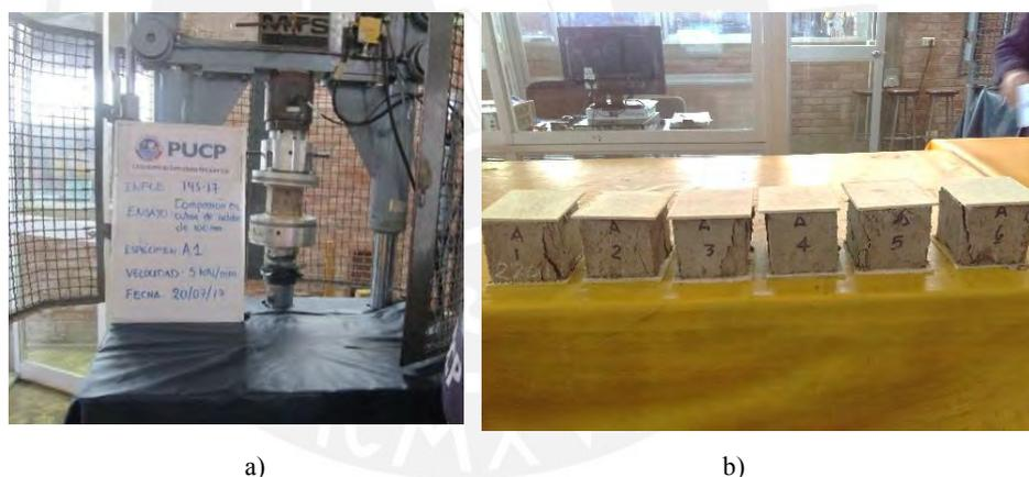
Figura 3.9. a) Ensayo de compresión en cubo de adobe A-1 de 100 mm de lado y b) Falla por aplastamiento en cubos
