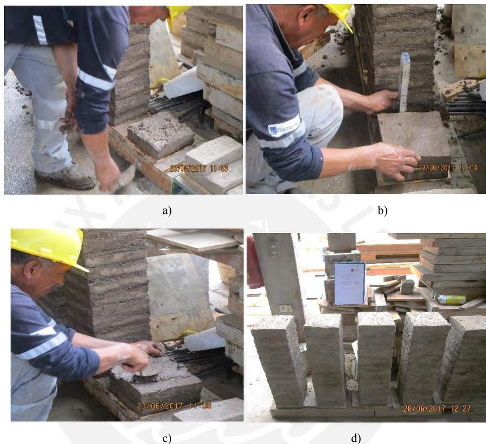
Figura 3.13. a) Asentamiento de unidades de adobe sobre tableros de madera, b) Verificación de la verticalidad de las pilas con plomada y nivel, c) Colocación de la junta de mortero de 8-10 mm de espesor y d) Especímenes en su etapa final de construcción
