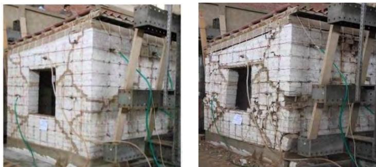
a) Módulo reforzado antes del ensayo      b) Módulo reforzado después del ensayo
