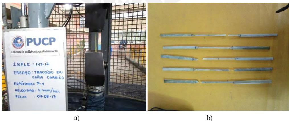
Figura 3.32. a) Ensayo de tracción en caña carrizo y b) Fallas en sección más delgada de las probetas
