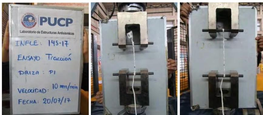
Figura 3.30. Ensayo de tracción en driza P-1
