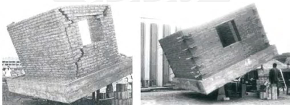
Figura 2.9. Ensayos estáticos en plataforma inclinable de módulos de vivienda de adobe sin refuerzo y reforzado con caña (Blondet et al, 2011)
