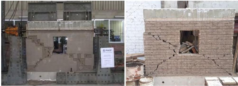
c) Muro MUERCR al término del ensayo (Fase 10)
