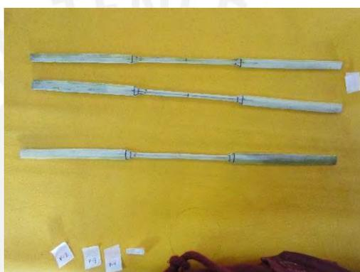
Figura 3.31. Preparación de especímenes de caña
