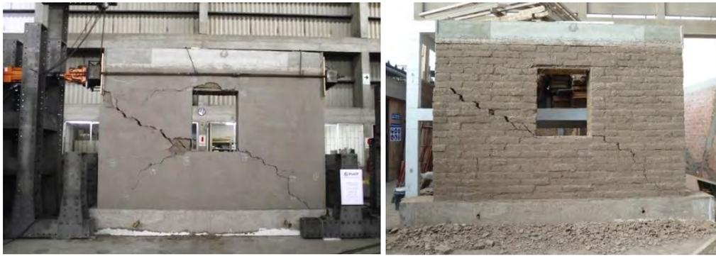
a) Muro MUENSR al final de ensayo
