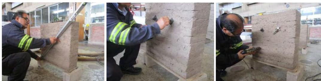
Figura 3.20. Colocación de Instrumentos en los muretes
