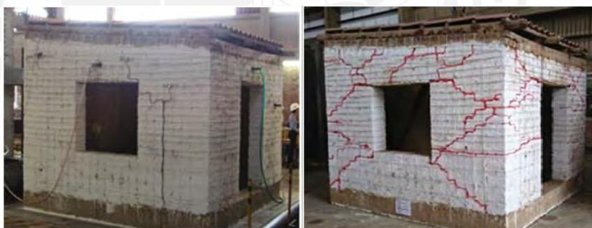
a) Módulo reforzado antes del ensayo      b) Módulo reforzado después del ensayo
