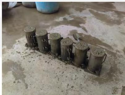
Figura 4.13. Probetas de concreto
