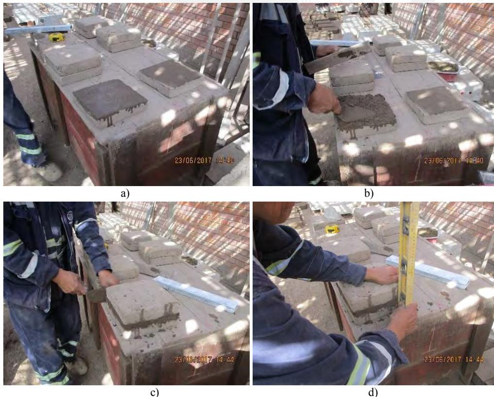
Figura 3.10. a) Humedecimiento de adobes, b) Colocación del mortero, c) Enrasado del emparedado y d) Nivelado del emparedado
